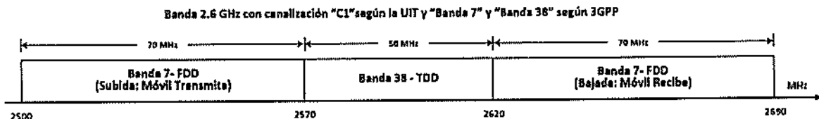
Figura N° 02.- Configuración de la Banda de 2.6 GHz
