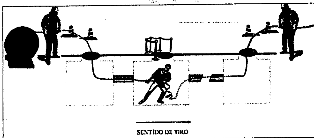
Figura 26. Tendido de Fibra Óptica Canalizada
