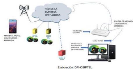
Figura N° 12.- Esquema técnico general del funcionamiento de las sondas embebidas
