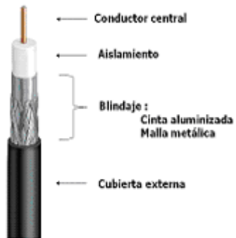
Componentes de un Cable Coaxial
