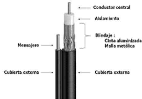
Componentes de un Cable Coaxial con Mensajero
