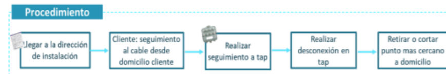
Figura 2. Procedimiento de Retiro de cableado
